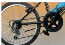
Le mécanisme du vélo (composé de chaîne, plateaux et pignons) permet de communiquer la force motrice fournie par le cycliste des pédales à la roue.
