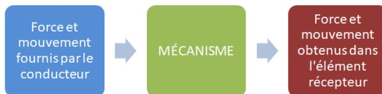
Chaque mécanisme de n'importe quelle machine sera composé en interne d'un ou plusieurs dispositifs appelés «opérateurs» (leviers, engrenages, roues, vis, etc.). Par exemple, le mécanisme de un vélo est composé de plusieurs opérateurs, tels que la chaîne et les engrenages qu'il relie (assiettes et pignons de pin).
